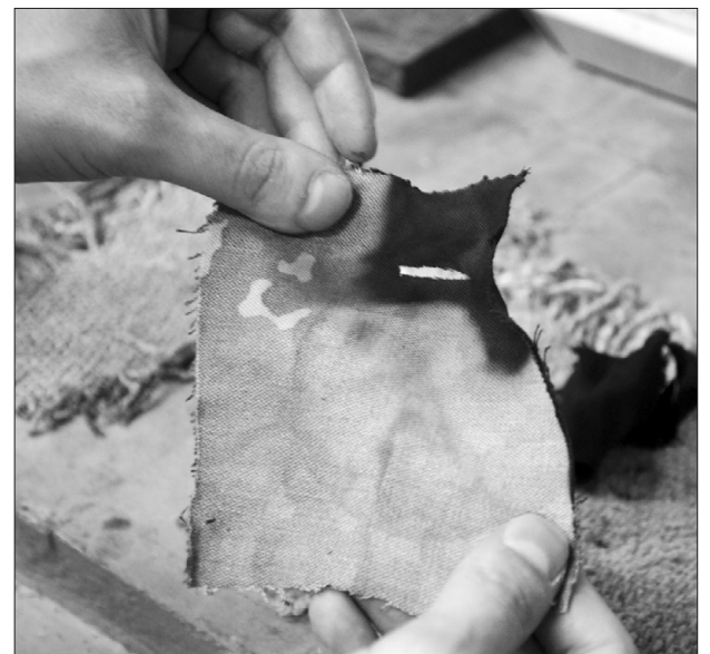
І майже не горить, а лише тліє зразок, оброблений “Феніксом”. Результат підпалу. Тканина обгоріла тільки збоку, але не повністю.
